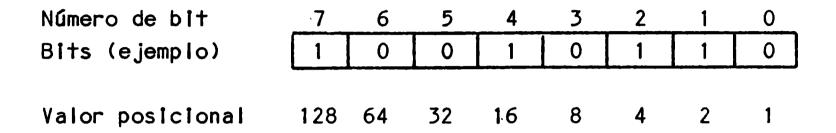
En este ejemplo pues, el byte tiene el valor decimal 128+0+0+16+0+4+2+0=150. Si con el comando POKE n,150 se "empuja" el valor 150 a la dirección n, en ella se definirá el bit tipo del ejemplo. Si con el comando PEEK (n) ''se echa un vistazo'' a la dirección n donde se encuentra nuestro bit tipo, el comando PEEK encontrará el valor decimal 150.
