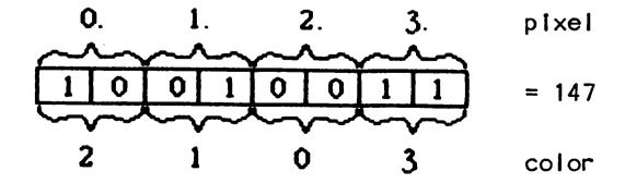
De esta forma, el byte de datos 147 origina una secuencia de cuatro pixels en los colores 2, 1, 0, 3. En la memoria de pantalla se coloca pues el valor de COLOR del pixel en forma binaria. A través del valor de COLOR se determinarán los correspondientes registros de color. Puesto que el comando PEEK halla sólo el valor decimal de un byte, los bits de varios pixels forman un valor decimal común.
