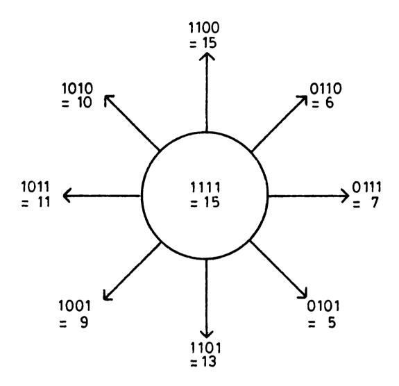
Posiciones del joystick Configuraciones del bit y valores decimales
